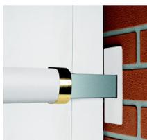
Dieser Panzerriegel ist nur manuell von innen bedienbar oder von innen und aussen mit Schlüssel und Zylinderschloss. Diese starke Sicherung wird verwendet um zusätzliche massive Sicherheit zu erlangen. Sie erschwert oder verunmöglicht ein Aufhebeln der Tür auf der Schloss- und Scharnierseite.
