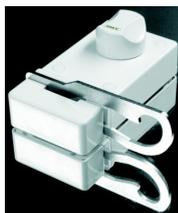
Dieses Zusatzschloss hat eine massive Gegenplatte mit integriertem Zylinderschloss auf der Tür-Aussenseite. Dieser massive Verschluss erschwert oder verhindert bei einem Einbruchversuch das Aufhebeln der Tür mit Einbruchwerkzeug. Der Bügel verhindert das Aufstossen der Tür, während eines Gesprächs mit Fremden an der geöffneten Tür.
